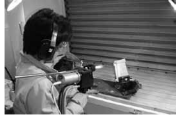
スプレーガンによる溶射作業
